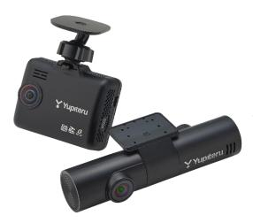
業界初のリアデュアルカメラを備えた、3カメラ型ドライブレコーダー。マルミエシリーズの全機能が搭載されたモデル。前方1カメラと、後方から左右と車内を記録するリアデュアルカメラをセットにし、従来の前後記録だけでなく、前後・左右・車内の記録を可能にした。搭乗者の顔や行動は記録しないプライバシー設計にもなっている。コストパフォーマンスと性能の高さから順調に販売を伸ばしている。
