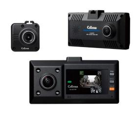
360度+リア型で初めて国内市場に投入されたドライブレコーダー。前方180度、左右と車内180度、後方を3カメラで録画する全方位ドライブレコーダー。急激な明るさの変化にも対応するハイダイナミックレンジ(HDR)や、暗所でもクリアに記録できるSTARVIS IMX307を搭載する。車内カメラには赤外線LEDを搭載。カメラ本体がコンパクト設計で、目立ちすぎないことも特徴のひとつ。広角レンズの組み合わせによるゆがみが少ない自然な映像記録が支持されている。
