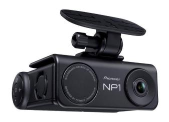
"会話するドライビングパートナー" として、音声で操作する「NP1」。従来 のカーナビゲーションの操作や確認では 目や手を使うものが多く、ドライバーに 負担がかかっていた。NP1は、声だけ で操作・案内するスマート音声ナビで運転に集中することができ、さまざまな車両に取り付けることが可能。また、前後 2カメラで映像がクラウドに録画される、ドライブレコーダー機能も搭載されている。常時通信されていることで、新
